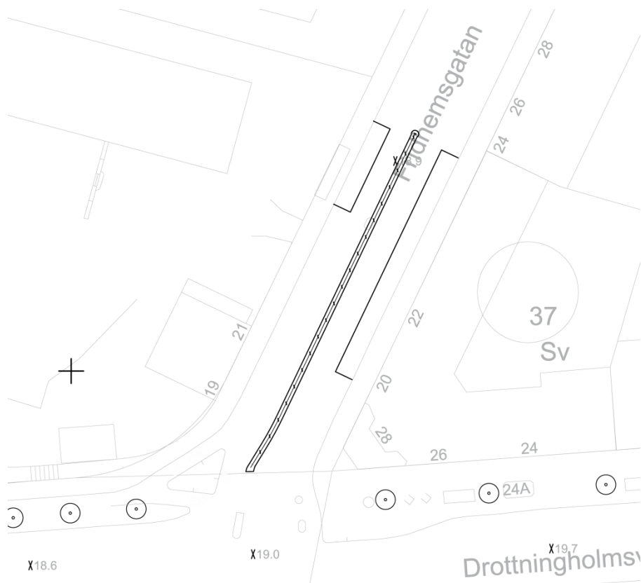
Figur 12. Skiss på en meter bred mittrefug och staket i mitten av Fridhemsgatan
